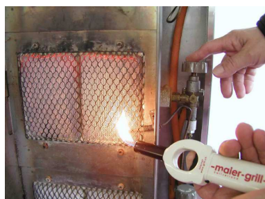
Beim Entzünden des Brenners muss der Regulierhahn so lange gedrückt werden, bis die Sonde heiss ist, ansonsten wird die Gaszufuhr unterbrochen.
