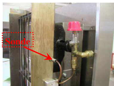
Die Gasauslaufsicherung stellt die Gaszufuhr bei Verlöschen des Brenners sofort ab.
