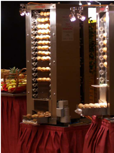
Der Maier Grill Torro L und S leisten rund 200 sowie 120 Grillspiese pro Stunde.
